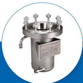
Typ(e) 3 Jacketed steel reactor with drain valve Stahlreaktor mit Doppelmantel und Bodenventil 0.5, 1.0, 1.5, 2.0, 3.0, 5.0 l 60 bar / 250°C
