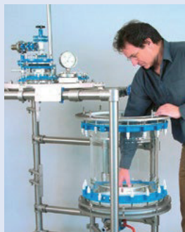
Swing-out mechanism for easy removal of the filter cake Ausschwenkmechanismus zur einfachen Entnahme des Filterkuchens
