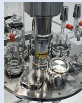
Büchi nutsche filters are also available as a clean-room setup Büchi Nutschenfilter sind auch als Reinraumausführung erhältlich
