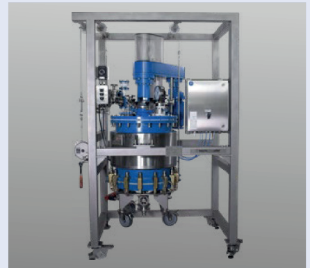
Glass-lined nutsche, high-adjustable agitator, 250 liter Emaillierte Nutsche, höhenverstellbares Rührwerk, 250 Liter
