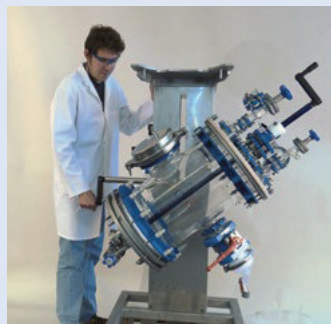
Turning of 30 liter filter vessel for discharge Drehung des 30 Liter Filtergefäßes zur Entleerung
