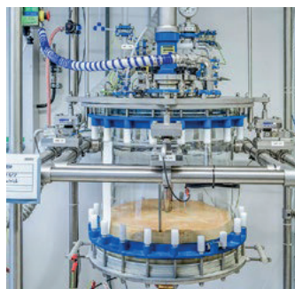
100 liter peptide synthesizer on load cells, fully automated dosing from feed battery, ATEX 100 Liter Peptid-Synthesizer auf Wägezellen, vollautomatisierte Dosierung von Zulauf-Batterie, ATEX
