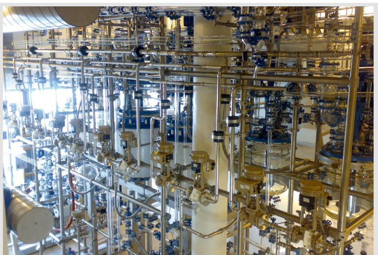
Glass tubing / piping – easy and safe due to flexible glass connection Glas Rohrleitungsbau – einfach und sicher durch flexible Glasverbindung
