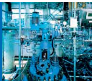
630 liter glass lined steel reactor with glass distillation overhead 630 Liter emailliertes Stahlreaktor mit Glas Destillationsaufbau
