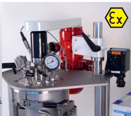
ATEX agitator drive ATEX Rührantrieb
