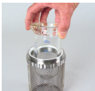
Vessel holder with protective wire mesh Gefässhalter mit Schutzgeflecht
