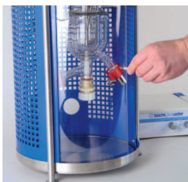
Housing with polycarbonate safety screen Gehäuse mit Polycarbonat Schutzscheibe
