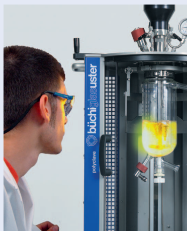
Visual supervision of reaction with glass vessels Visuelle Überwachung der Reaktion mit Glasgefässen
