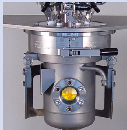
Sight glass on 60 bar pressure vessel / 60 bar Druckbehälter 60 mit Schauglas
