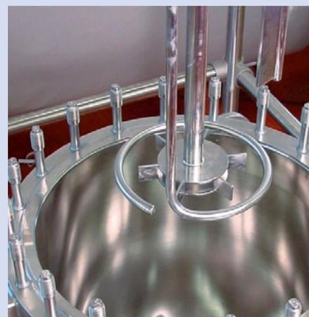
Gas introduction in 100 liter reactor with turbine stirrer / Gaseinleitung in 100-Liter-Reaktor mit Begasungsrührer
