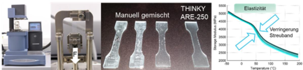
Abbildung 3, v.l.n.r.: DMA-Messgerät; Nahaufnahme Probenklemmbereich; Unterschiede in der Probenherstellung bei manuellem Mischen und Mischen durch den THINKY-Mixer ARE-250; Verringerung der DMA-Messabweichungen durch bessere Probenqualität
