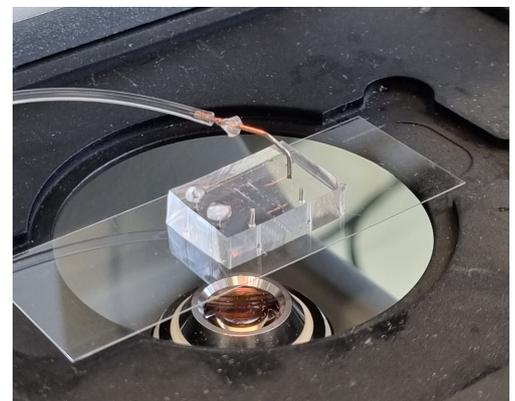
Abb. 2: Mikrofluidik-Chip aus PDMS
