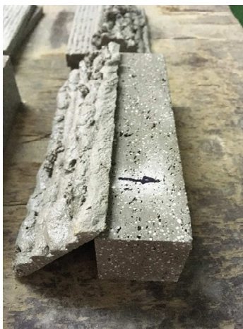
Abbildung 2: Aus extrudiertem Bauteil herausgesägter Probekörper zur Bestimmung der Festbetoneigenschaften sowie Verhältnis von Rohdichte des Materials zu Wärmeleitfähigkeit (C. Matthäus)
