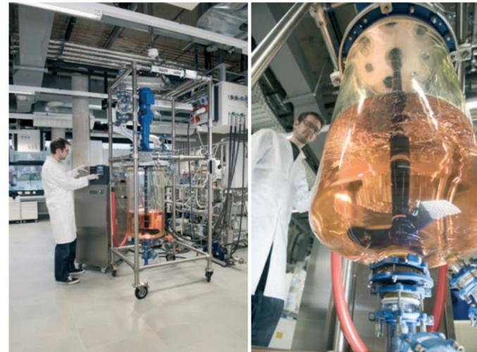
Abbildung 2: 100 Liter Büchi Rührreaktor als zentrales Element im Projekt CO-PILOT
