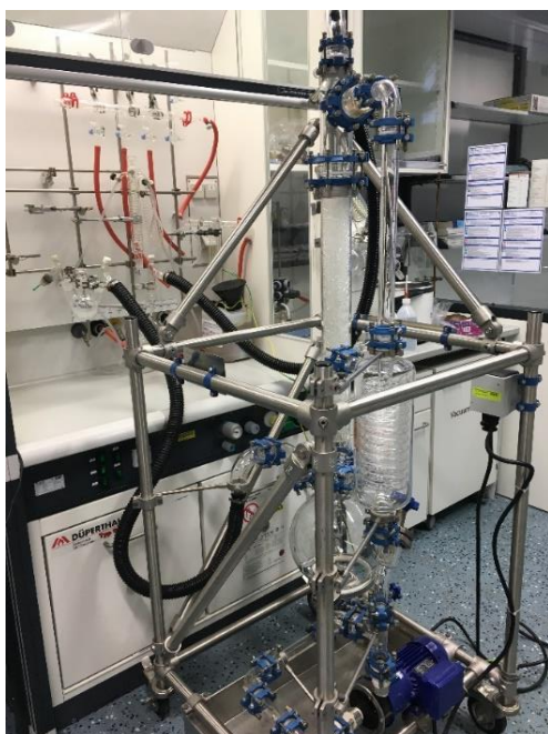
Abb. 2: 10-Liter-Gaswäscher der Firma Büchi AG
