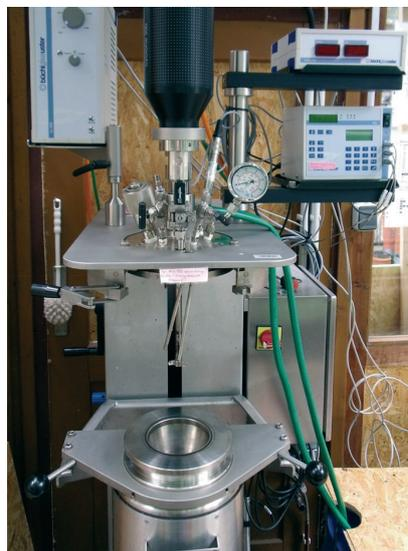
Abb. 2: Büchi “kiloclave” 0,5 Liter Druckreaktor
