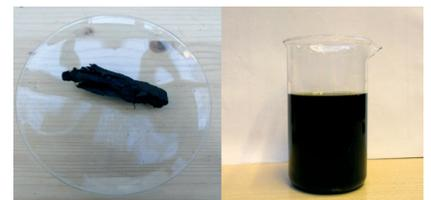
Abb. 3: HTC Produkte: “Hydrokohle” und Prozesswasser
