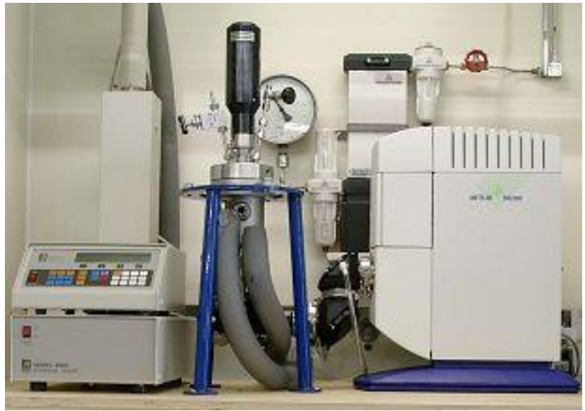
Anlagenbild: 1. Hochdruckautoklav mit ATR-IR-Sonde und FTIR-Spektrometer
