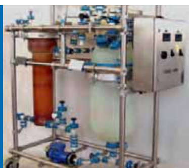
UV-reactor with brown stained glass UV Reaktor mit brüniertem Glas
